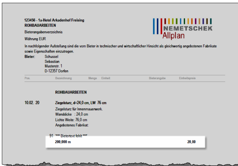
Abbildung 20: Ausgabe eines Verzeichnisses aller Bieterangaben über den Bericht Bieterangabenverzeichnis, nun mit Angabe der Positionsmengen und –einheiten sowie optional der Einheitspreise.
