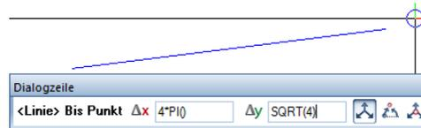
Abb.: Rechenoperationen:  $DX = 4\pi$ ,  $DY = \sqrt{4} = 2$
