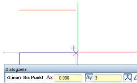
Abb.:  $DY=3$  wird beim neu gefangenen Punkt wieder vorgeschlagen
